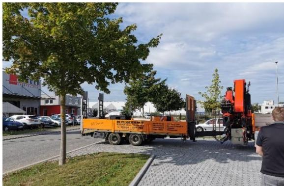
Im folgenden Versuch haben wir uns an einem Montagvormittag ein Stahlrollenbereiftes 12t Fahrzeug mit einer Punktlast von 40kN nachgebaut.
