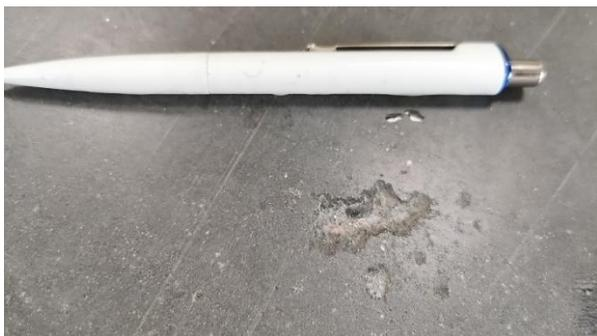
Selbst eine Sechskantschraube, zwischen dem Rad und der Oberfläche, schadete unserer Bodenplatte nur rein optisch und das mit einem geringen Ausmaß.
